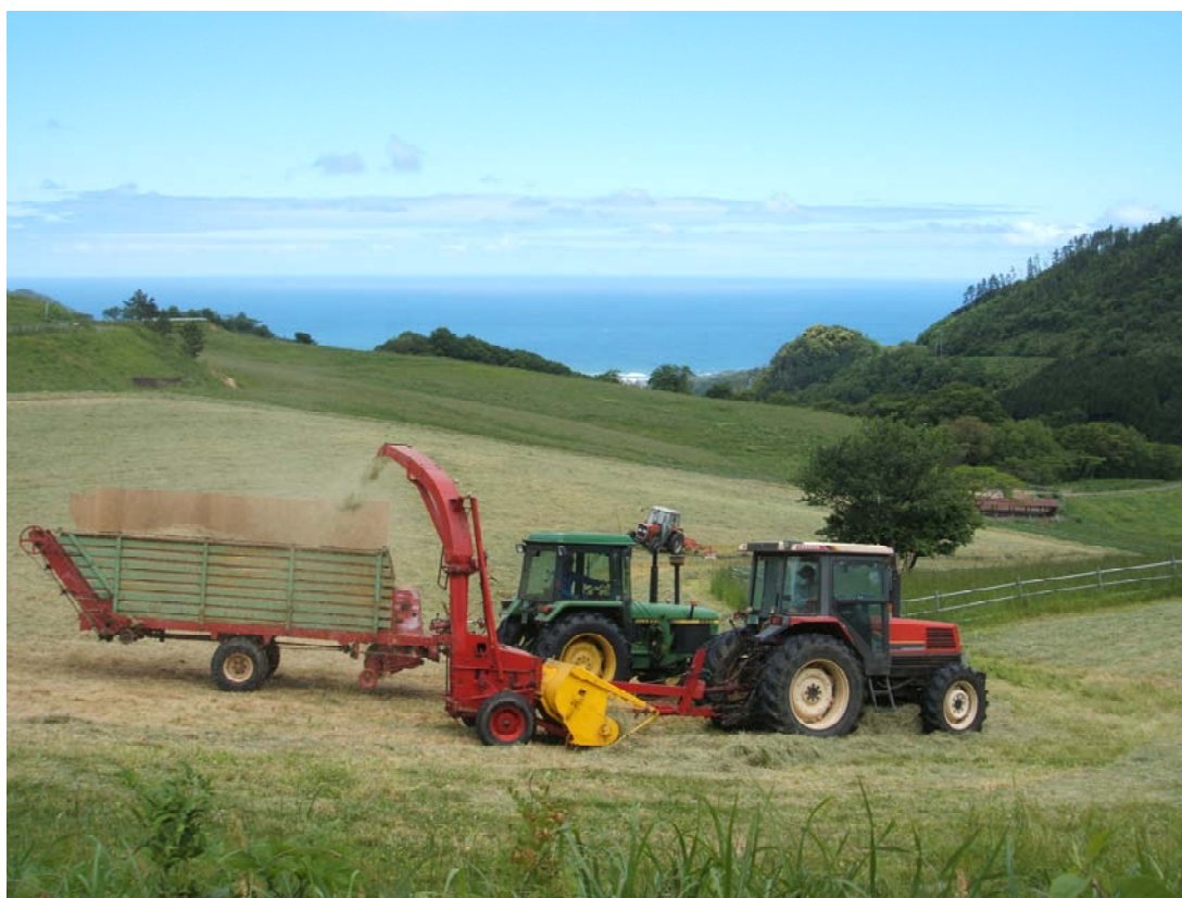
ピックアップハーベスタとファームワゴンの併走による作業
