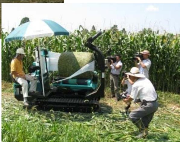
専用フィルムで密封し、乳酸発酵させます
