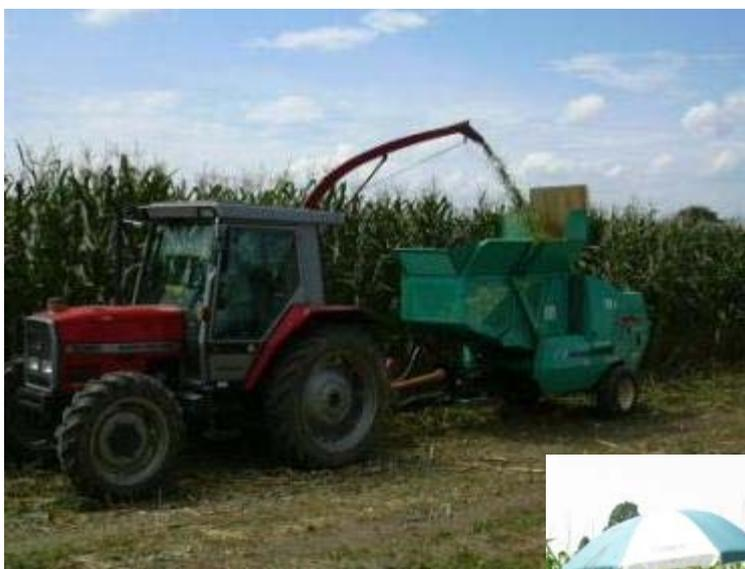
2～3cmに細断し、直径85cm、高さ85cm、重量330kgの円筒形に成型します。
