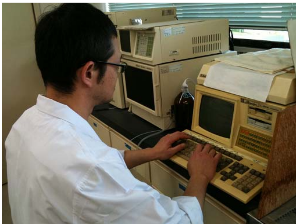
高速液体クロマトグラフで血中ビタミンA濃度を測定しモニタリングします
