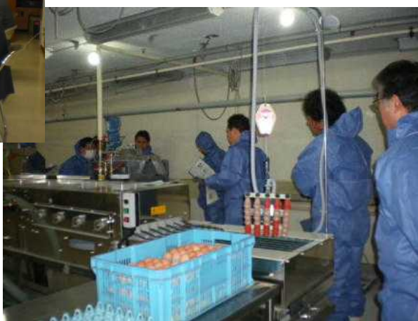
試作装置で洗卵消毒効果を確認
