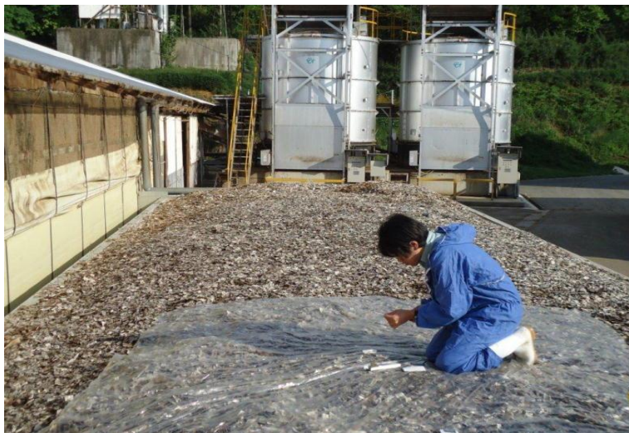
脱臭装置で臭気測定 (写真奥が縦型コンポ)
