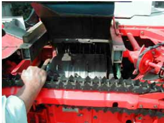
写真1 改造前のコンバインのこぎ胴部
