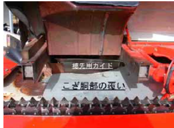
写真2 こぎ胴部の改造後
