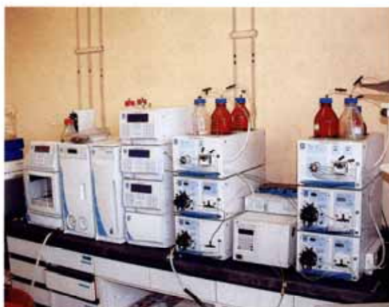
図1 ポストカラムイオンクロマトグラフ シアンや臭素酸及び亜硝酸塩素等の陰イオン類の検査に用います。
