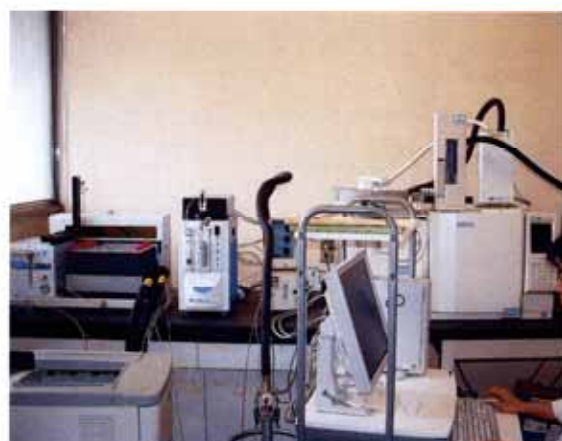
図2 パーシットラップガスクロマトグラフ質量分析計 かび臭物質(ジェオスミンと2メチルイソボルネール)の検査に用います。
