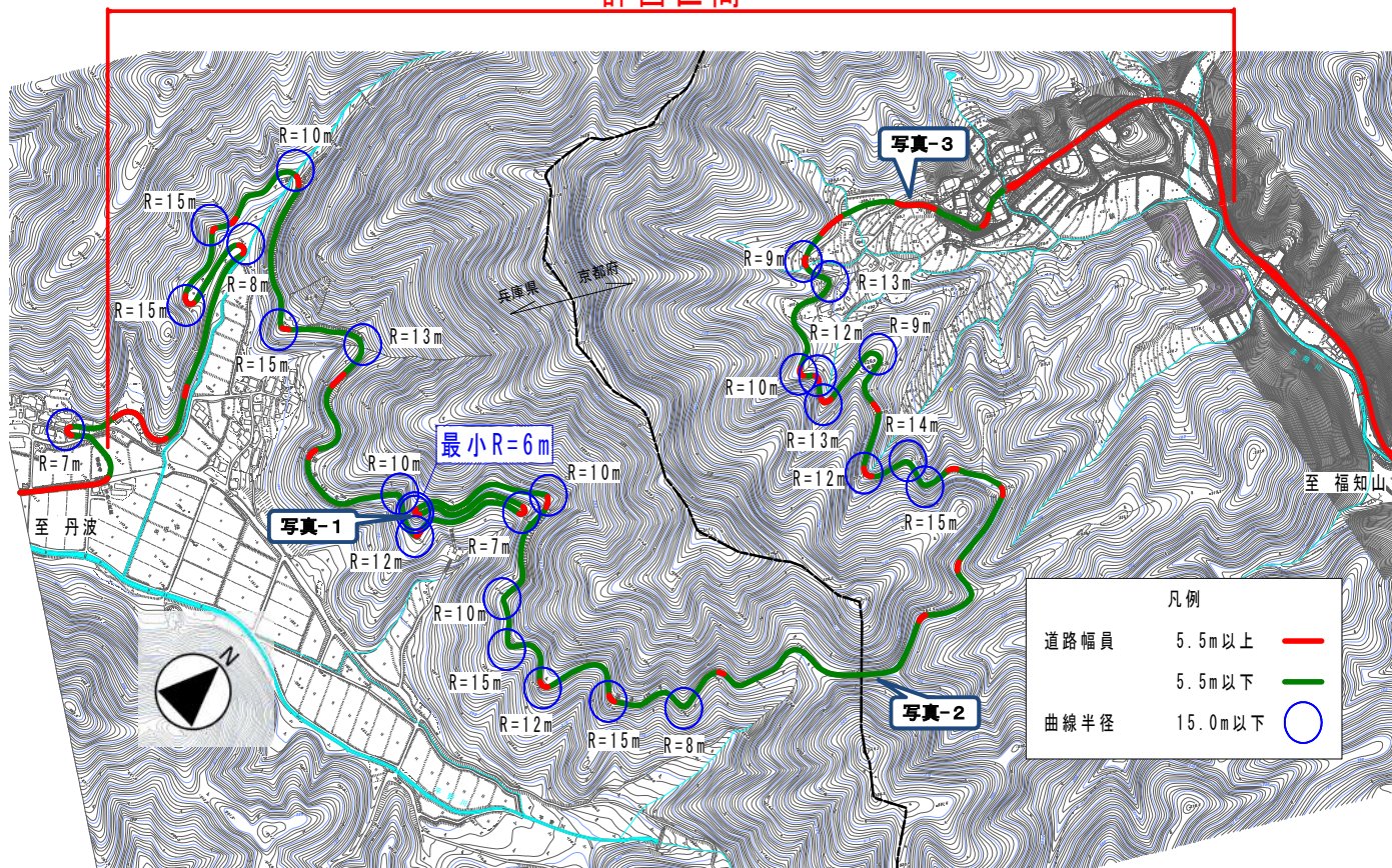
【図-5 現況道路の幅員と曲線半径】
