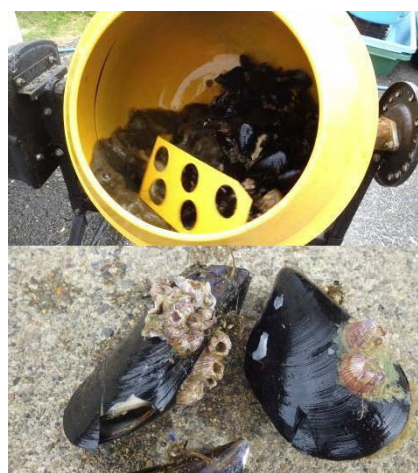
図 15 コンクリートミキサーを用いた付着物の除去試験（写真上）と殻が割れてしまったムール貝（写真下）
