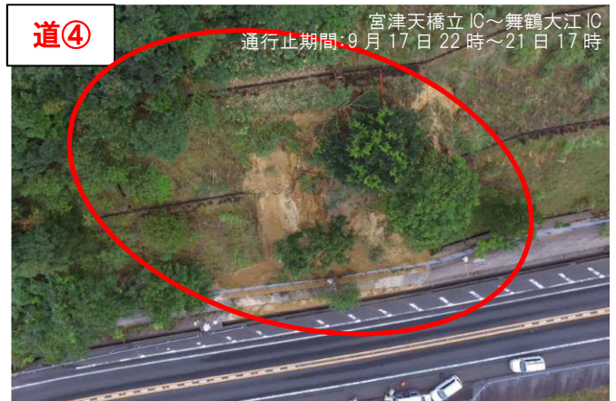
道④ みやづし きょうとじゅうかんじどうしやどう 【場 所】宮津市 京都縦貫自動車道 (国道 478 号) 【被災状況】法面崩壊 延長 35m (2 箇所 2 工区) 【復旧内容】吹付法柁 100,000 千円 宮津天橋立 IC～舞鶴大江 IC 通行止期間: 9 月 17 日 22 時～21 日 17 時
