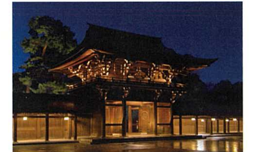
外から見えない位置に灯具を設置して軒下をライトアップすると、軒下の繊細なディテールが印象的に見える。
