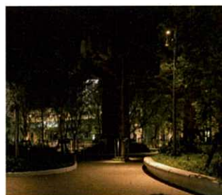
①ポールスポットライト ポールにスポットライトを設置したタイプで光が欲しい場所を的確に照らすことが可能。スポットライトが横向きに設置されていると、通行人にグレア (不快なまぶしさ) を与えてしまうのでなるべく下に向ける。
