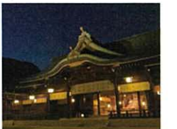
外観全体を照らすよりも特徴的な建築意匠だけを集中して照らすことで、陰影のバランスに富んだ見え方になる。
