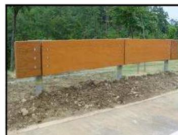
間伐材ガードレールの研究開発(耐候性試験中)
