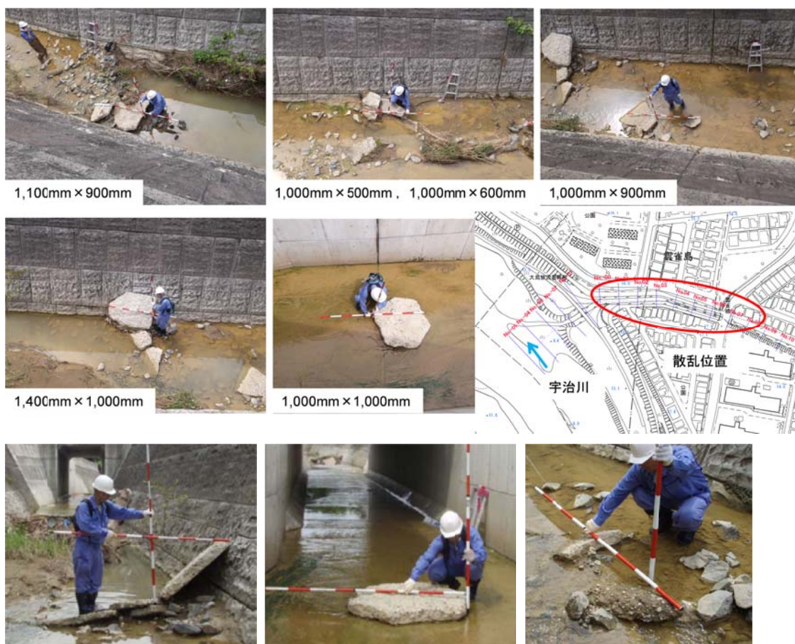
図- 4.17 河口部の流下物状況(コンクリート片)
