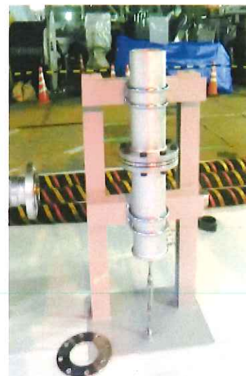
大容量ポンプ海水系統～冷却水系統 接続ディスタンスピース入替訓練設備
