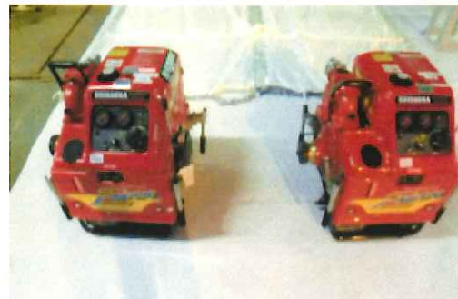
消防ポンプ起動手順訓練設備
