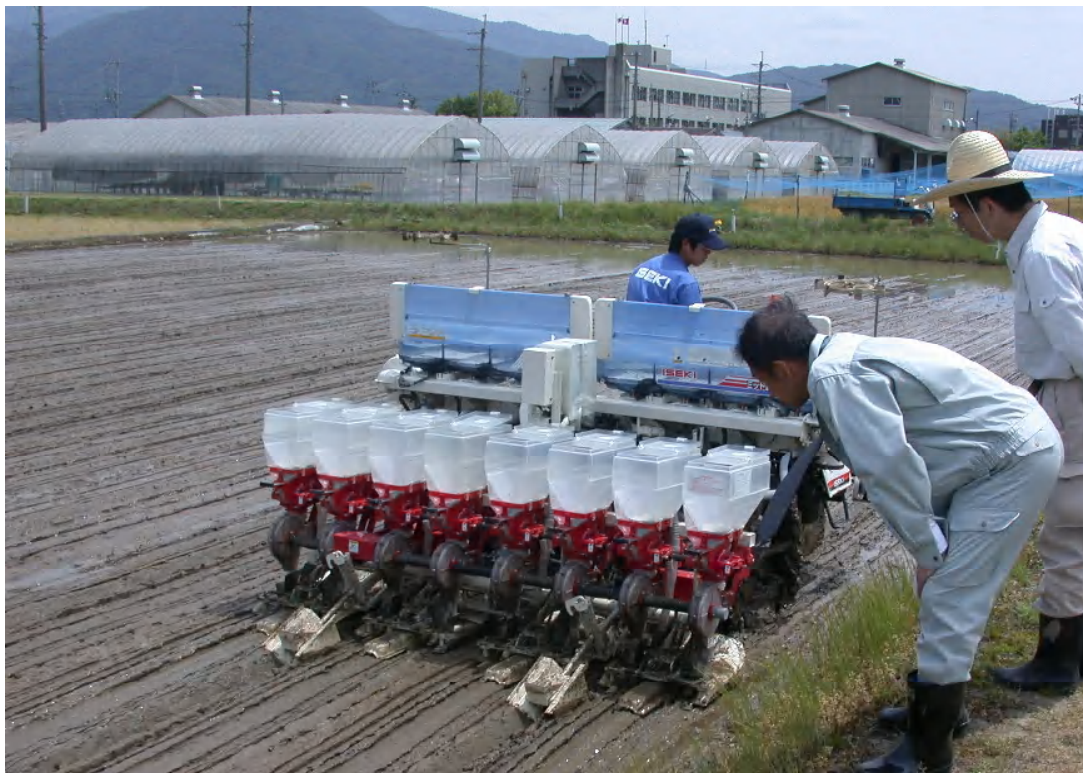
湛水点播直播機(8条播き)による実演。4条おきに溝切りを行う。
