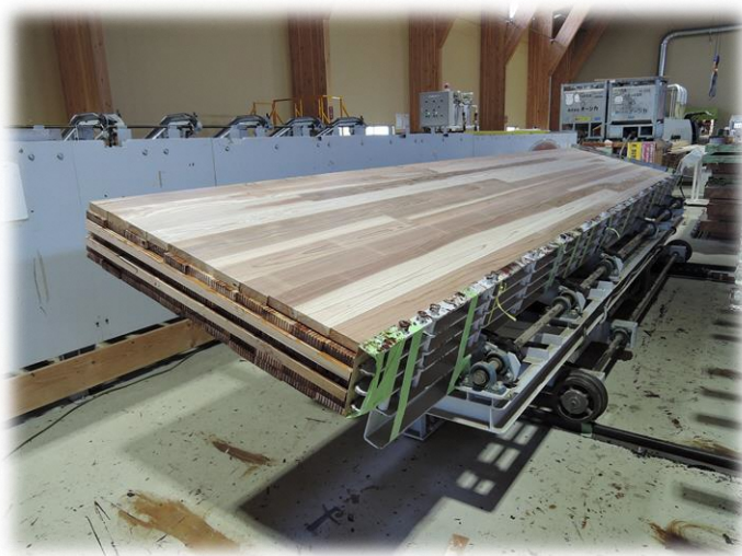
CLT製造ライン
