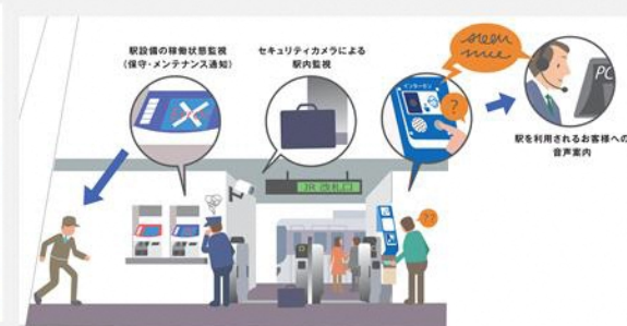
設備・カメラ遠隔監視システム
