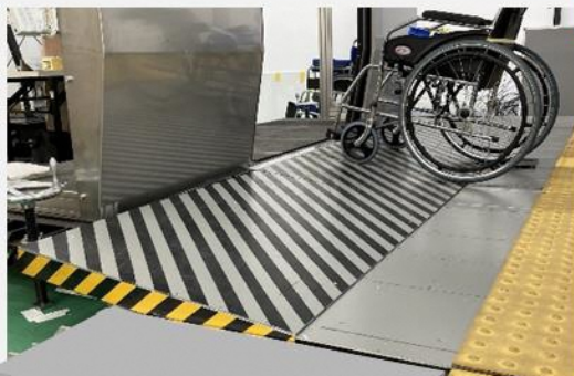
車椅子の乗降を目的とした可動ステップによる段差解消機
