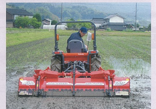
専用ハローによる浅水代かき作業。土が7～8割見える状態で代かきをするため、田植え前に落水しなくて良い
