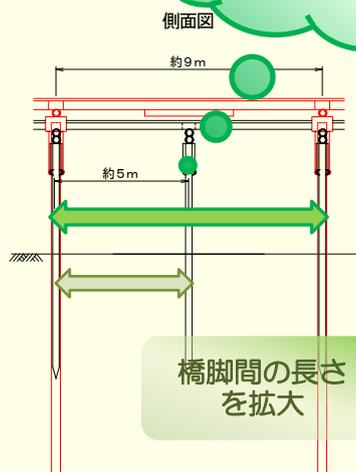
橋脚を洪水に強い構造にします。
