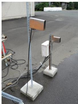
写真4 光電センサと制御盤のユニット
