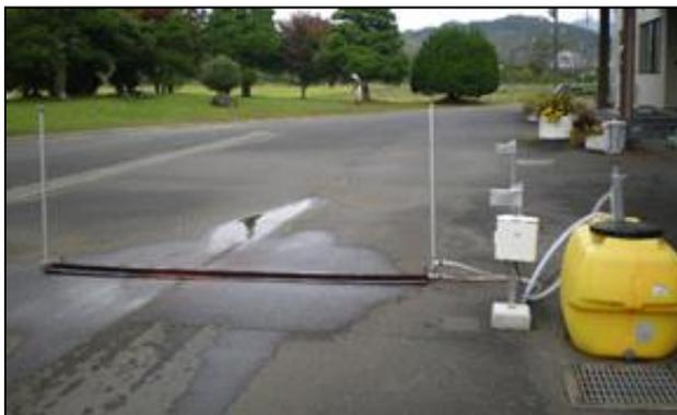
写真 1 試作した自動式車輻消毒装置の全景
