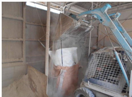
写真 1 フレコンバッグへの詰め込み
