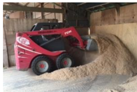
写真 5 オガクズと焼却灰及び消石灰の混合
