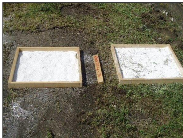
写真1 粒状消石灰散布状況
