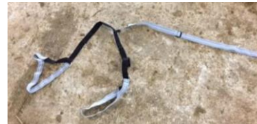
図 1 手芸用織りゴムで作成した取付具
