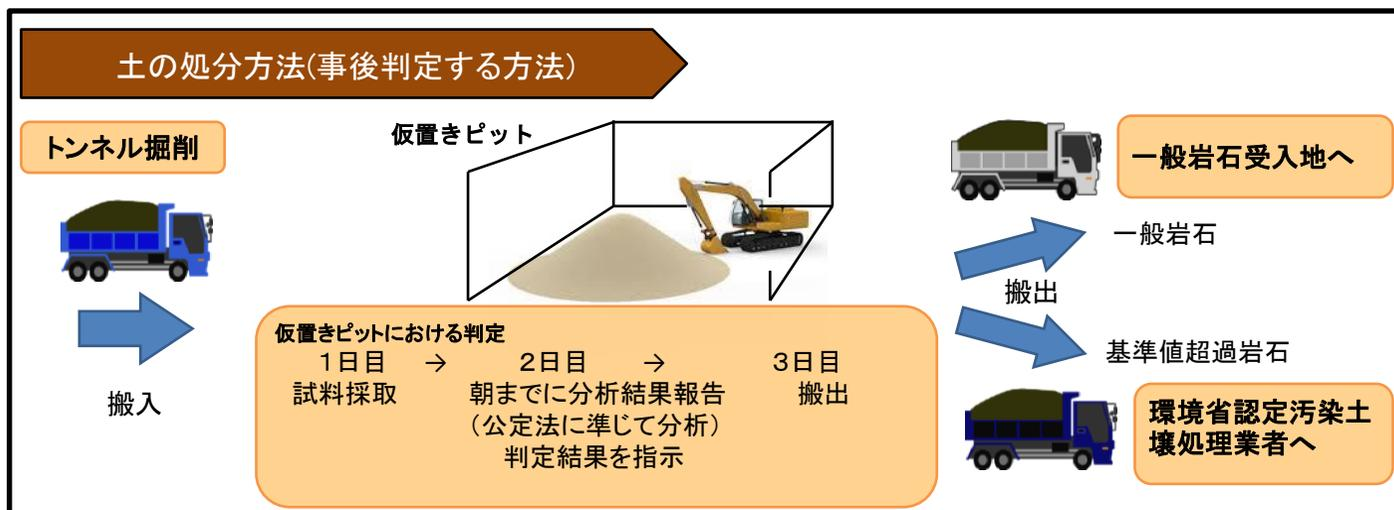
▲前回変更から一般岩石と基準値超過岩石を分別して処分する方法を継続して実施
