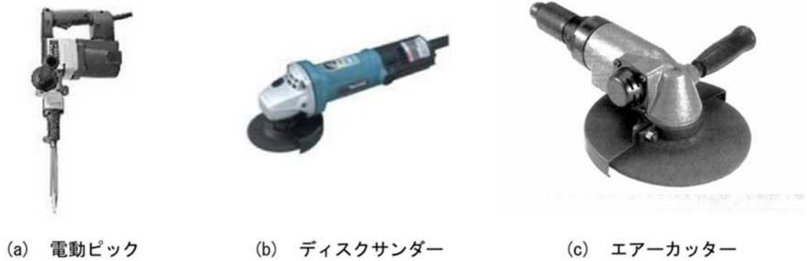
写真 4.3.1 はつり落とし工の機材
