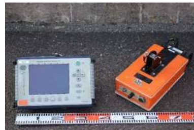
写真-2.3.2 地中レーダー装置外観
