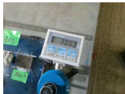
炭素繊維付着量試験 3.05\text{kN} \geq 1.5\text{kN}
