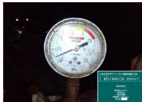
S008+0.71 注入圧確認 (実績0.2MPa以上 ≥ 設計0.2MPa)
