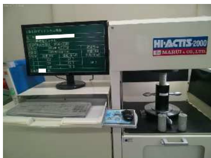
無収縮モルタル4週強度試験 (実績68.2N/mm 2 ≥ 設計45N/mm 2 以上)
