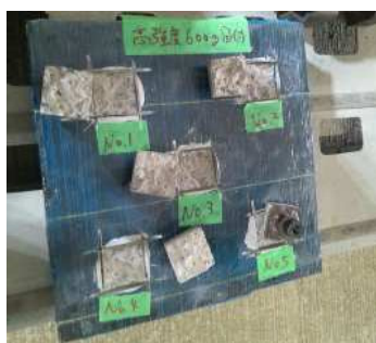
炭素繊維付着量試験 (はく離に要する引張力が設計の 接着力1.5kNを上回るかを確認)
