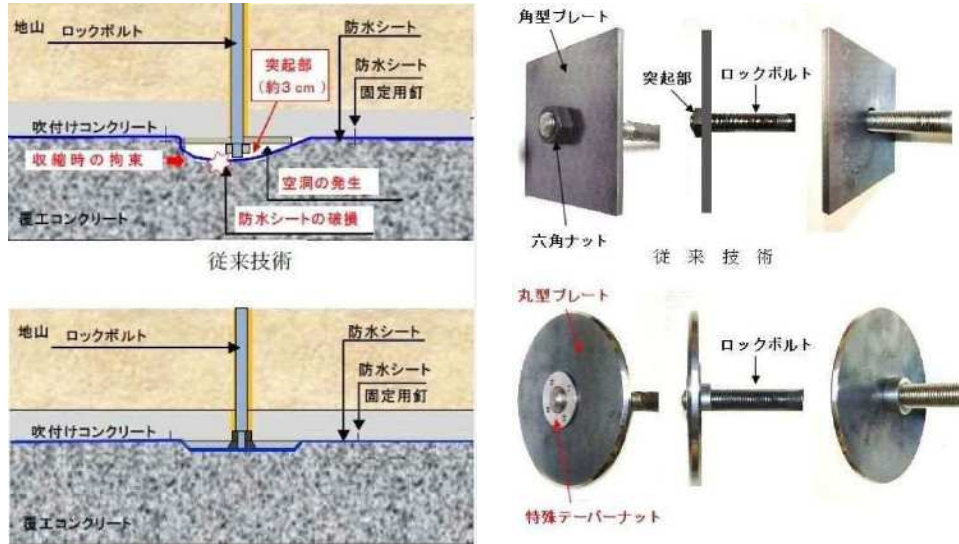
図 7.1.15 突出レスロックボルト 33)
