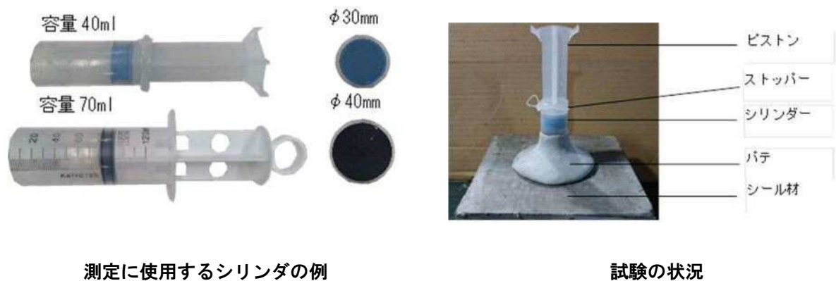
図 7.3.4 シリンダを用いた簡易透気試験の概要
