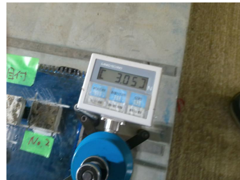
炭素繊維付着量試験 3.05\text{kN} \geq 1.5\text{kN}
