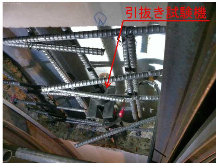
引抜き試験実施状況 5.00\text{KN} \geq 3.47\text{KN}
