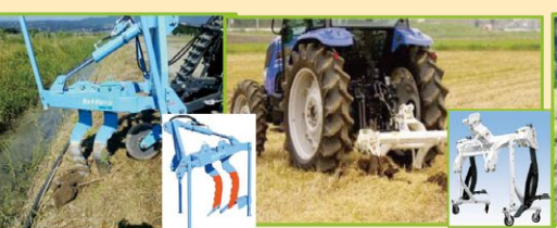
排水改良等の作業機(補助暗きょ)の導入 (写真左はカットドレーン、写真右はサブソイラ)※
