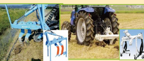
排水改良等の作業機(補助暗渠)の導入 (写真左はカットドレーン、写真右はサブソイラ)※
