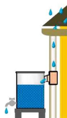
雨水貯留施設の仕組み
