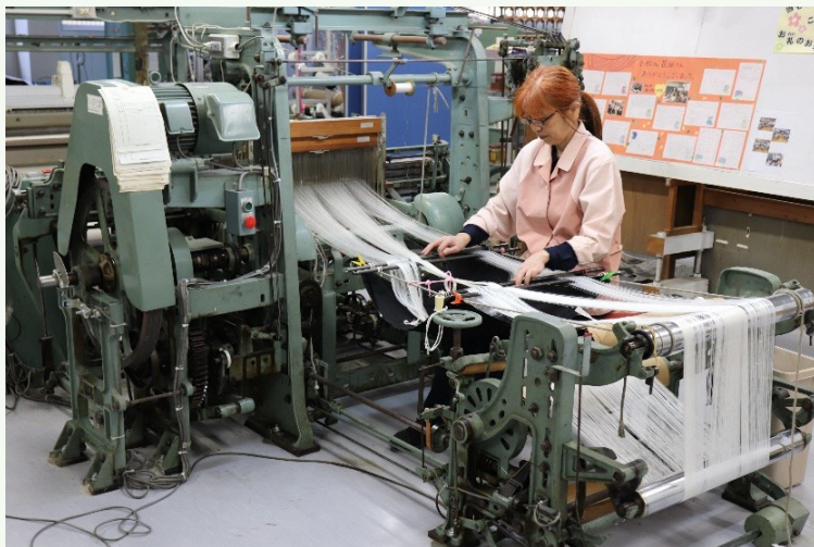
織物試料の作製風景（たて継ぎ）
