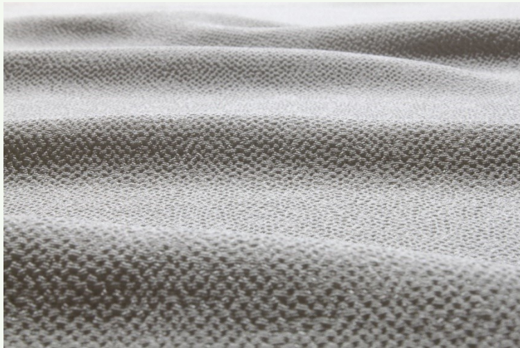
シボ（撚糸の収縮による凹凸形状の発現）
