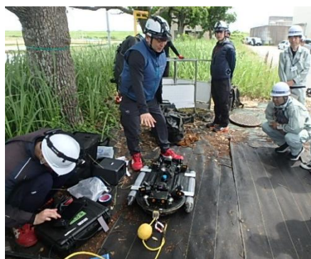
水上走行型ドローンを用いた下水道管渠調査 (木津川流域下水道事務所)
