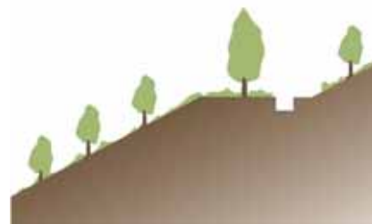
法面の斜面や小段への緑化例 小段部：中高木植栽 斜面地：苗木植栽、地被植栽等
