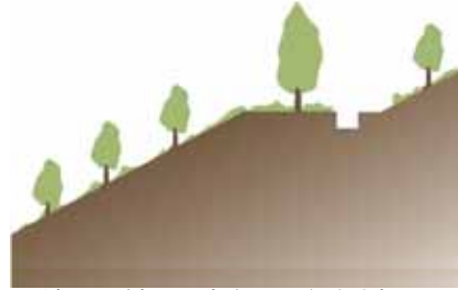
法面の斜面や小段への緑化例 小段部：中高木植栽 斜面地：苗木植栽、地被植栽等
