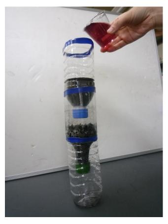
液体を流した後は、汚れがペットボトル浄水器の中に残っています。 かんさなコップ 2杯分の水 (約 200mL) を流して中を洗ってから、次の液体を流しましょう。
