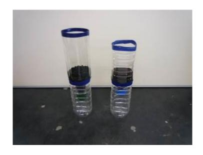
③写真のように、活性炭の入ったペットボトルの上に砂の入ったペットボトルをセットします。 で割れないかを確認してから、上からかさなコップ 2杯分(約200mL)の水を流します。
