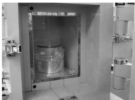
10cm程度の鉛で囲った遮へい体の中に入れた蛇口水の試料。外部からの自然放射線を遮って、試料から出てくる放射線を測定します。
