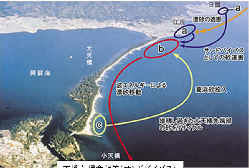
天橋立 浸食対策(サンドバイパス)
