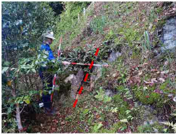
NO. 60～NO. 61 付近。岩盤に開口亀裂が確認された。亀裂の間隔は約 1m。
