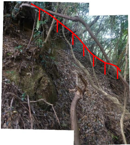
【写真番号⑫】 測点 NO. 38 付近の斜面中腹の滑落崖
