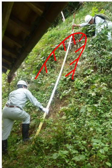
【写真番号⑭】測点 NO. 40 付近の表層崩壊跡(右)と斜面下部の転石(左)
