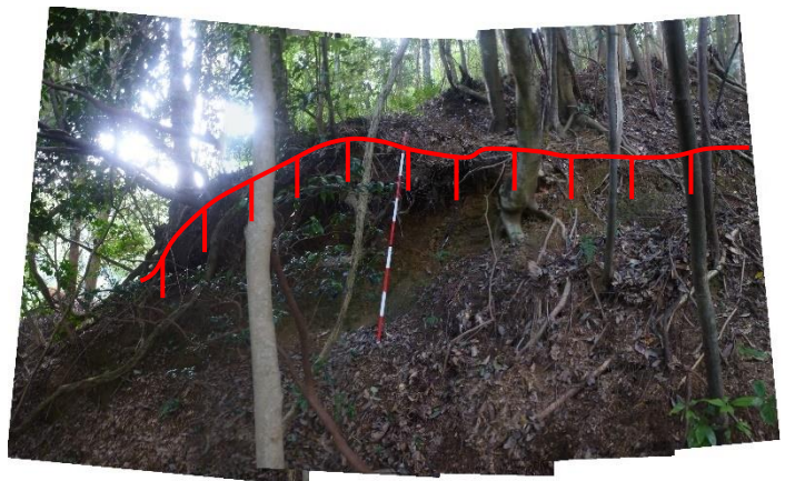
【写真番号⑫】 測点 NO. 38 付近の斜面中腹の滑落崖
