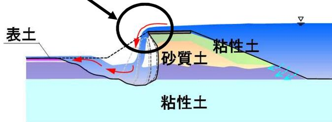
堤防天端をアスファルト等で保護した堤防では、ある程度の時間、アスファルト等が残っている。
