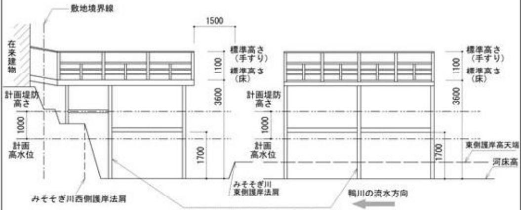
床の柱を鉄材とする場合は原則、柱形状の角材(コラム)を用いるものとする
