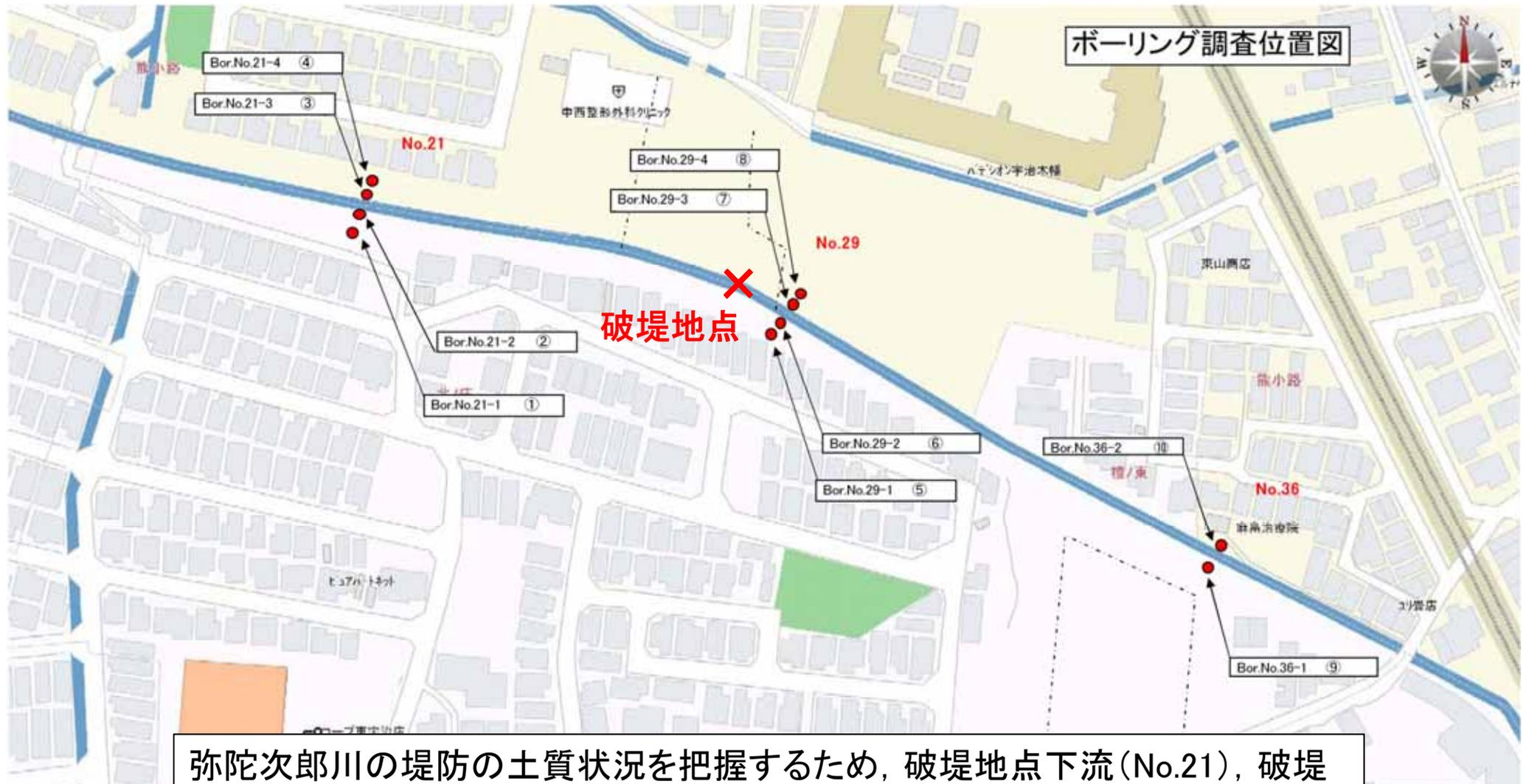
弥陀次郎川の堤防の土質状況を把握するため、破堤地点下流（No.21）、破堤沈直近（No.29）、破堤地点上流（No.36）の3断面で合計8本のボーリング調査を行った。
