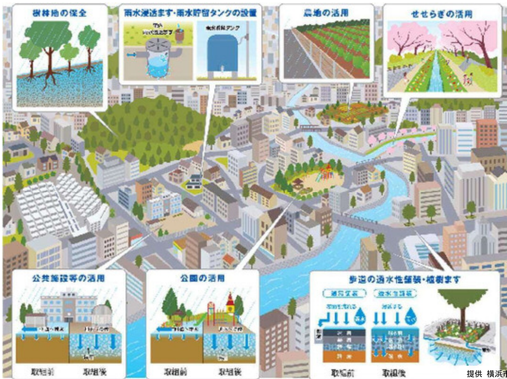
側溝・保水性舗装から入った雨水は、雨水貯留浸透基盤により地表までしみ上がり、蒸発散作用により気温の低減効果が発揮 提供 グリーンインフラ総研
