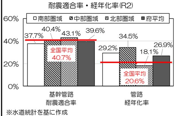
基幹管路：導水管、送水管及び配水本管（給水分岐のないもの）
