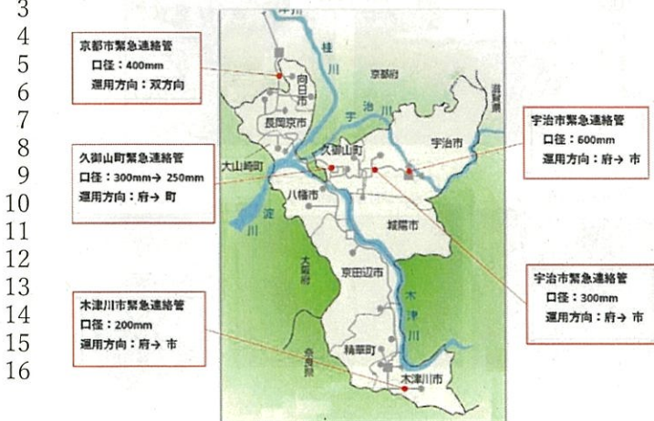
1 [資料 3-3-2 京都市・受水市町との 2 緊急連絡管の整備状況]
