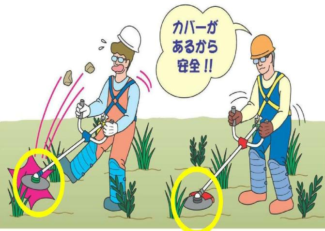
飛散防護カバーは作業の方へ飛散物が飛ばないようにするための物です。**カバーを装着し、安全に作業しましょう。**
