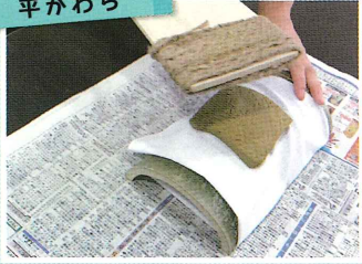
竹台に乗せた粘土をたたき、成型します。
