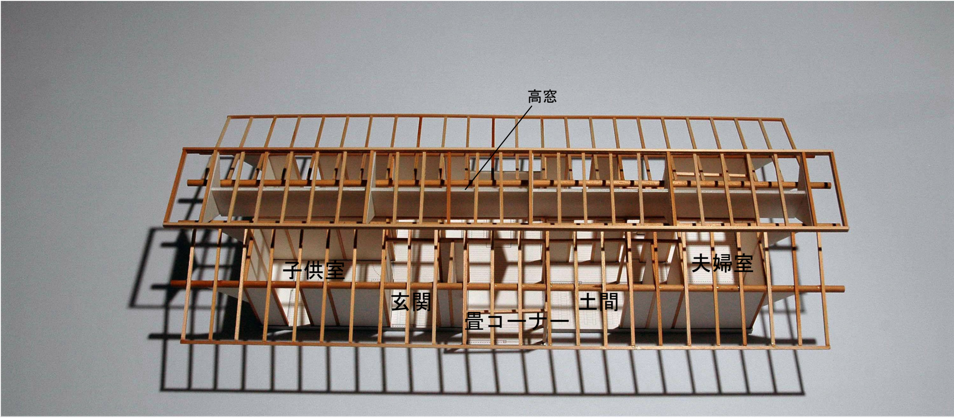
梁伏(上レベル)
