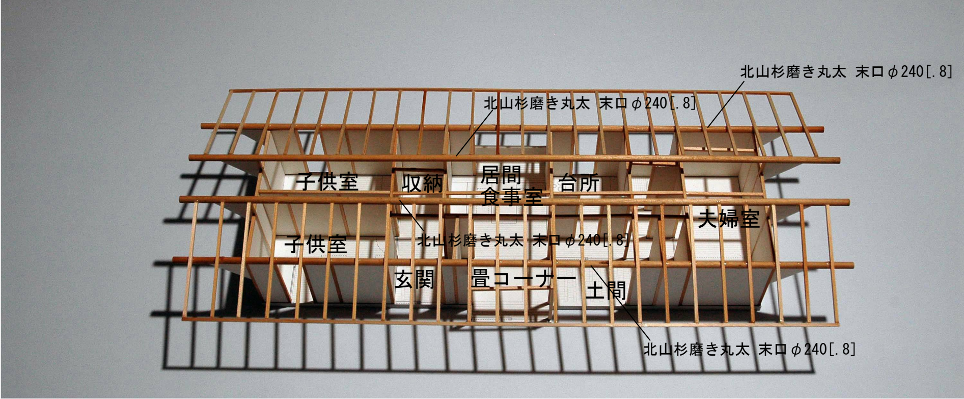
梁伏(下レベル)
